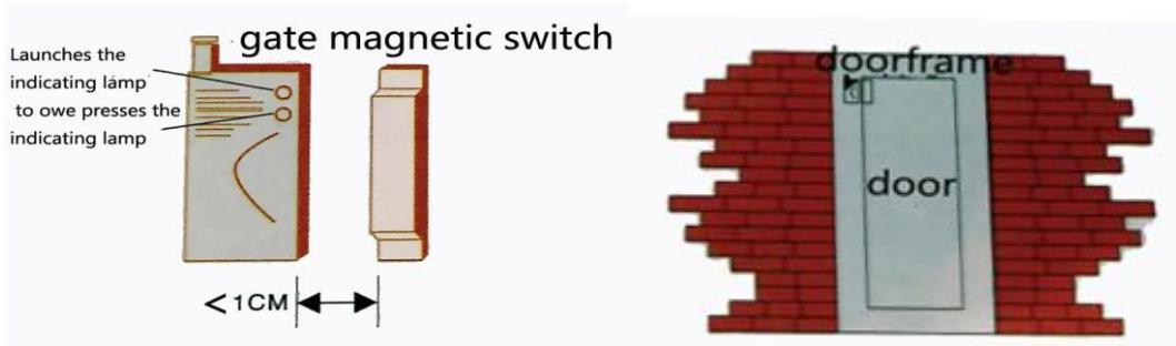
(Рисунок слева: дверной магнитный датчик. Расстояние между магнитом и ответной частью <1 см., запуск индикаторной лампы, индикаторная лампа. На рисунке справа показано размещение датчика на двери).
